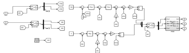
Figure 6: DQ controller subsystem
