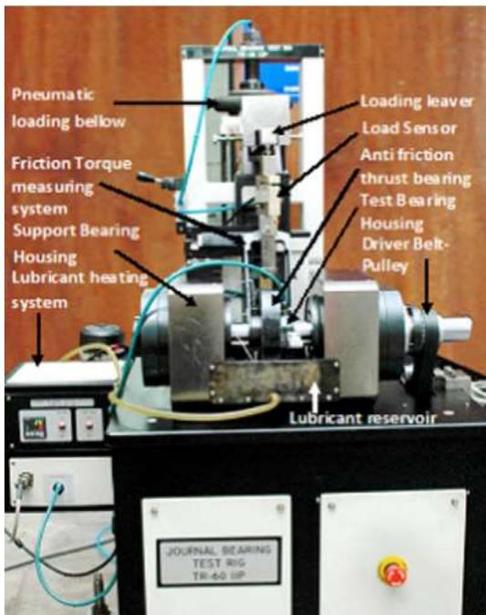
**Fig. 2:** Journal bearing test rig
